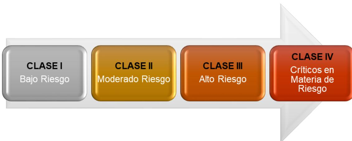
**Figura 1: Sistema de clasificación de equipos y dispositivos médicos**
